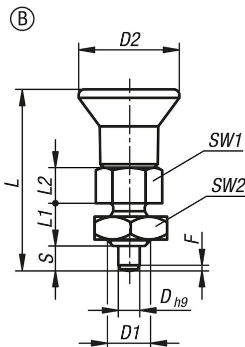
**Упорные штифты ESO из обычной стали или нержавеющей стали, короткое исполнение, с пластмассовой грибовидной ручкой и контргайкой**
