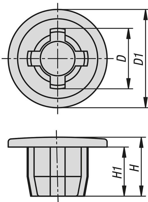
**Закрывающаяся пробка из пластмассы для половин петель****Обзор изделий**
