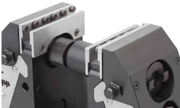
Заготовка в зажатом состоянии. Закреплена в тисочных губках, которые оснащены зажимными шипами.
