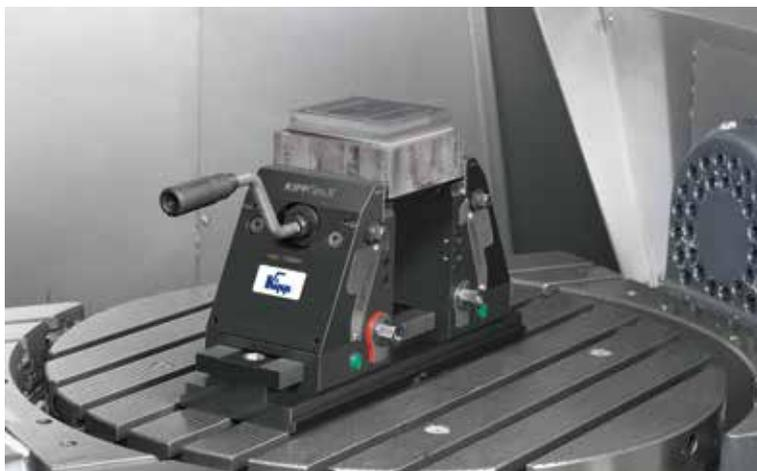
Прижим с помощью KIPPFlexX. Оба зажимных кулачка закрыты; такое положение кулачков позволяет выполнить надежный прижим опоры обрабатываемой детали.
