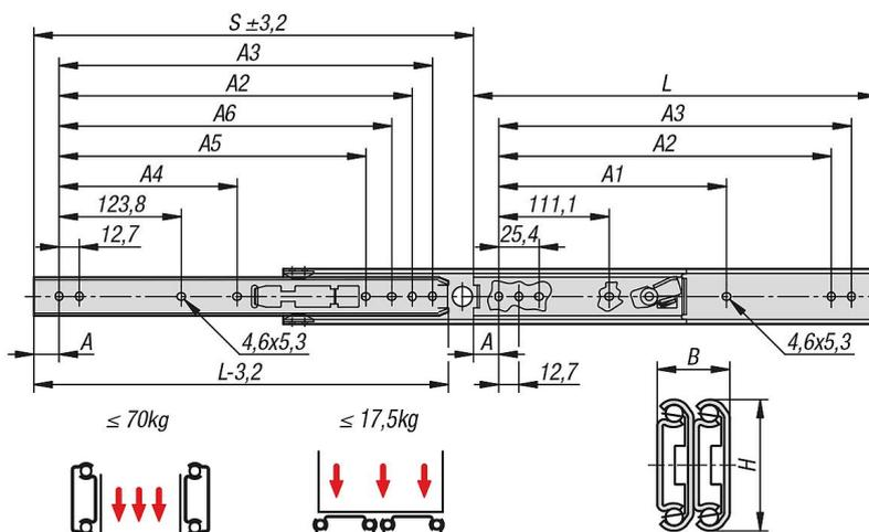
**Телескопические шины из стали для бокового монтажа, сверхвыдвижение,
