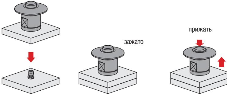
Установите зажимной замок над зажимным болтом, не нажимая кнопку, таким образом зажимной замок будет зафиксирован.
