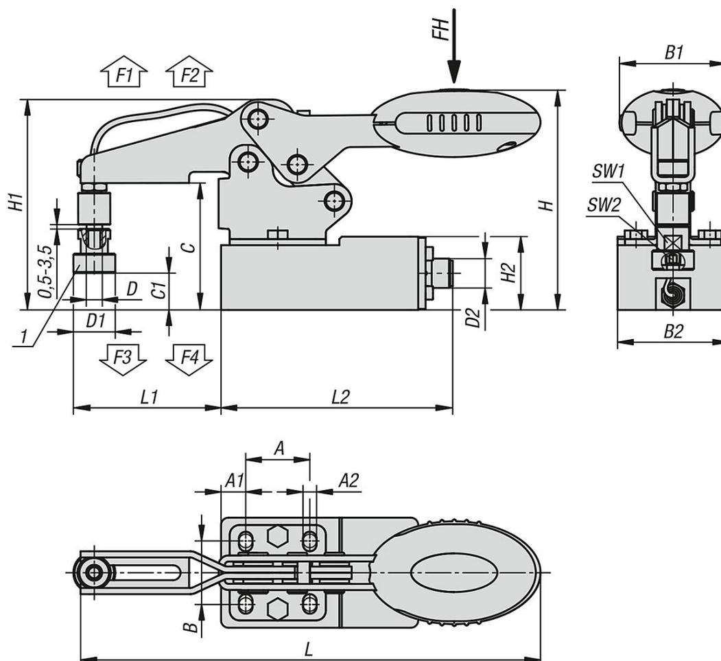
**Быстрозажимное устройство из нержавеющей стали горизонтальное исполнение, с датчиком усилия прижима**
