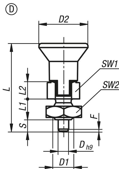
**Упорные штифты ESO из обычной стали или нержавеющей стали, короткое исполнение, с пластмассовой грибовидной ручкой, фиксирующим пазом и контргайкой**
