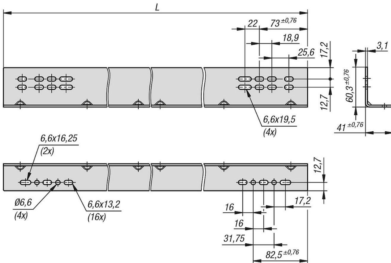
**Стальной монтажный уголок для телескопических шин****Обзор изделий**
