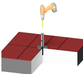
3. Inserire il perno filettato o il bullone e fissare al pavimento (ad es. con la colla).
