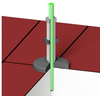
4. Il piedino regolabile e la macchina sono fissati completamente e saldamente (senza fori visibili nel pavimento).
