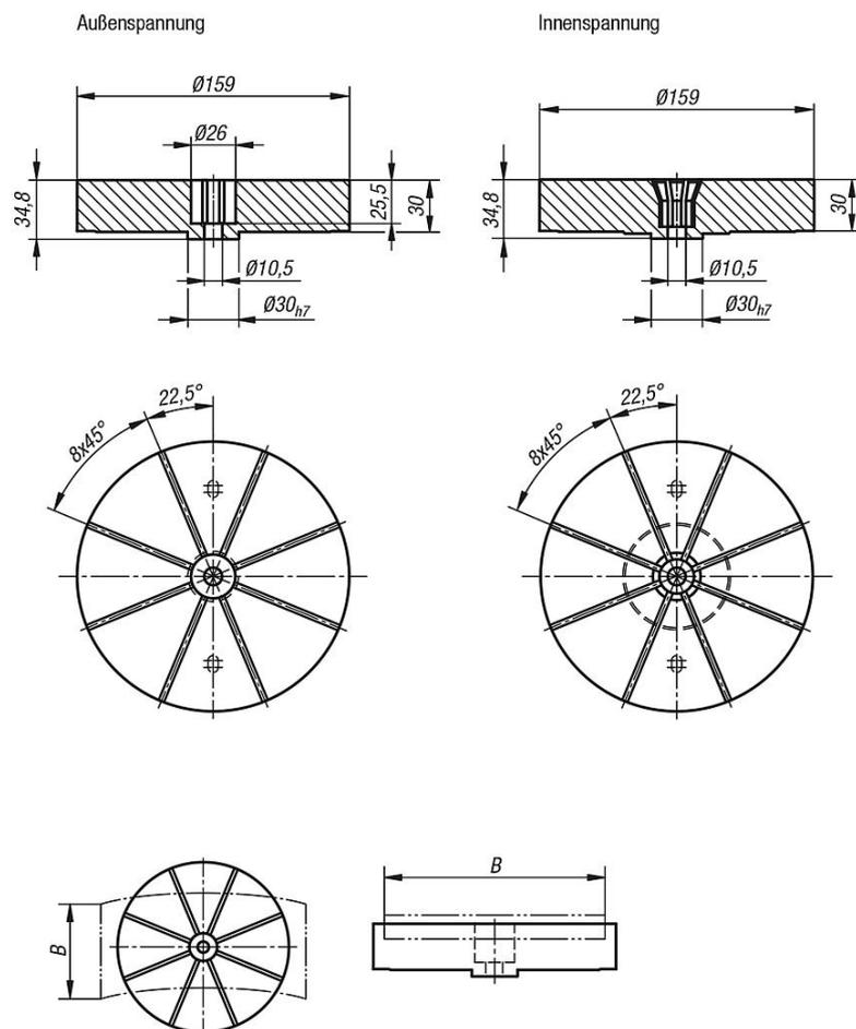
Die Werkstückbreite „B“ sollte maximal 90% des Spannzangendurchmessers betragen.
