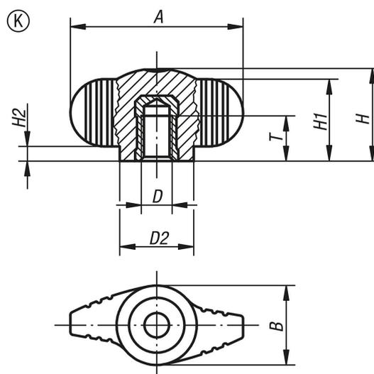
**Flügelgriffe "Miniwing" antibakteriell mit Innengewinde, Stahlteile****Edelstahl**
