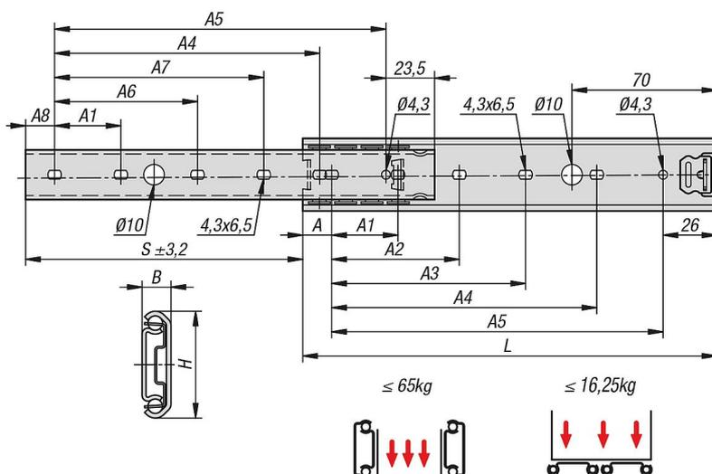
**Телескопические шины из нержавеющей стали для бокового монтажа, частичное выдвигание, грузоподъемность до 65 кг**
