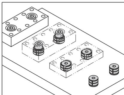
Pour une bonne répétabilité, la pièce doit être positionnée sur le dispositif de positionnement. Le serrage s'effectue au moyen de la bride de centrage.
