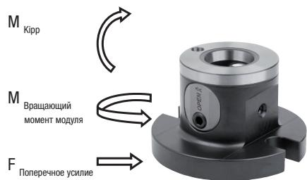
\* Надлежащая работа зажимных модулей, в особенности, точность повторяемости обеспечивается при поперечном усилии до 1.000 N. Надежность на отказ зажимных модулей и безопасность обслуживающего их персонала обеспечивается до критического поперечного усилия в 7.000 N.
