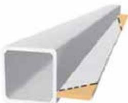
Bei einem Gehrungsschnitt erfolgt ein 90° Schnitt am Vierkant und ein 45° Schnitt am Steg.
