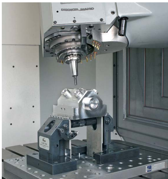
Werkstücke lassen sich mit dem 5-Achs-Spanner von Kipp in einer Aufspannung störkantenfrei komplett von 5 Seiten bearbeiten. Die direkt unter der Werkstückauflage angebrachte Zugspindel sorgt für einen kurzen Kraftfluss beim Spannen.
